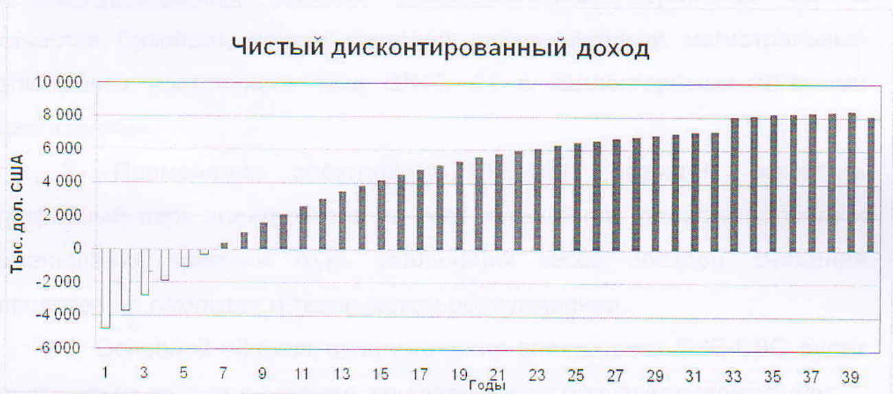
Рисунок 9 – Чистый дисконтированный доход от использования электровоза СКЕ-СВС, и интерпретация срока окупаемости
