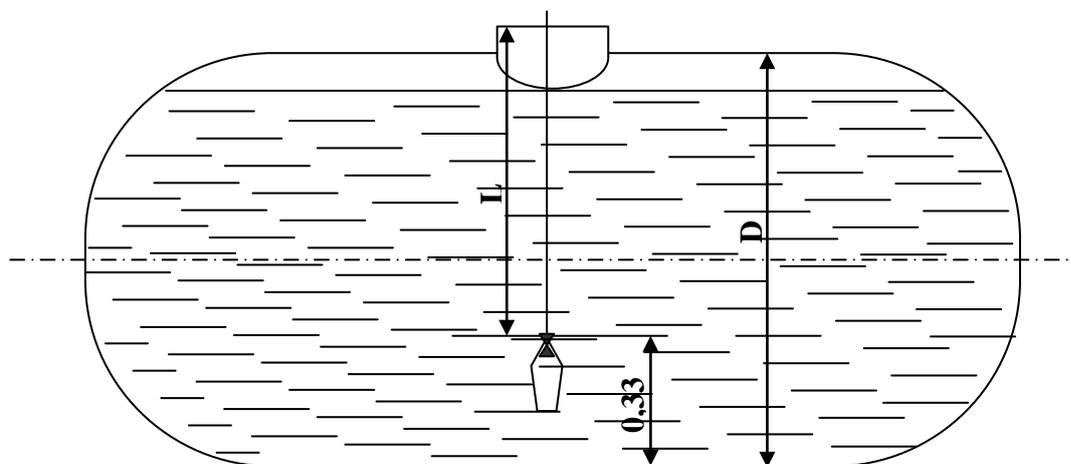
Рис. 1 Схема отбора проб нефтепродуктов из железнодорожных цистерн
