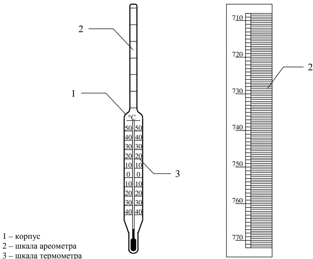
Рис. 3 Ареометр
