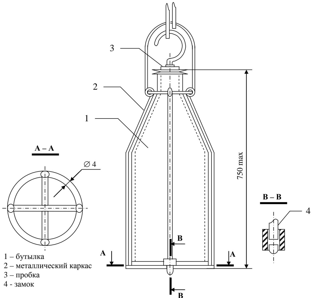
Рис. 2 Переносной пробоотборник
