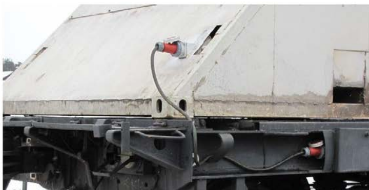
Рисунок 69 – Примеры подключения АДГУ к сети электроснабжения платформы а – подключение АДГУ «Прогрессор-01»; б – подключение АДГУ РКВ-15
