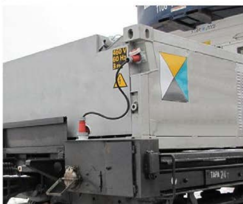
Рисунок 69 – Примеры подключения АДГУ к сети электроснабжения платформы а – подключение АДГУ «Прогрессор-01»; б – подключение АДГУ РКВ-15
