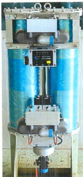
Рис.9.2 Внешний вид воздушной сушилки
