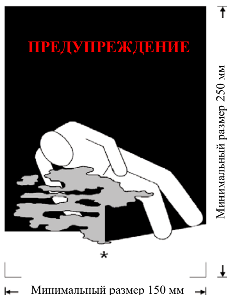
Маркировочный знак, предупреждающий об опасности асфиксии, для вагонов и контейнеров
